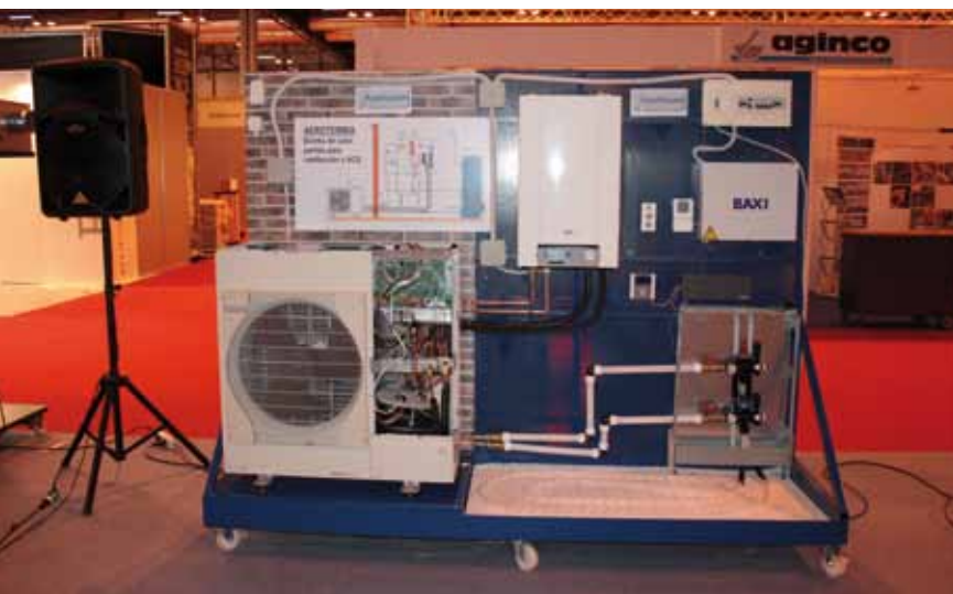
Sistemas de climatización mediante aerotermia.
