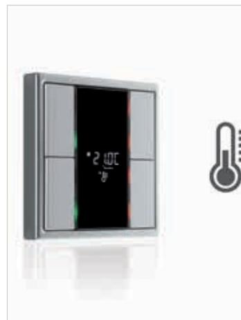
En cuanto a clima, el controlador de estancia compacto F 50 ofrece cuatro opciones para determinar la temperatura real de la estancia: en primer lugar, directamente a través del sensor de temperatura integrado; en segundo lugar, a través del sensor de temperatura de un módulo de ampliación conectado; en tercer lugar, por medio de una sonda conectable opcionalmente y, para finalizar, con el sensor de temperatura de cualquier dispositivo KNX, a través de un telegrama tipo float de 2 bytes.
