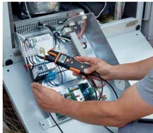
Comprobar de forma fácil y segura la corriente o tensión en un cuadro eléctrico es esencial, y, por ello, Testo dispone del comprobador de tensión y corriente testo 755 con autodetección de parámetros. Este producto ofrece todas las funcionalidades de medición de tensión, resistencia y corriente que necesita un técnico de HVAC a diario.
