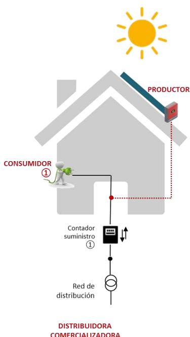
En esta configuración existe un **único consumidor** asociado a la instalación en autoconsumo que, mientras tenga demanda, utilizará toda la energía producida por la instalación (fotovoltaica en el ejemplo) en cada momento.
