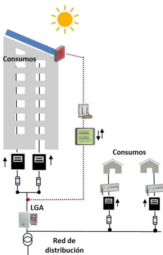
Existen varios consumidores asociados que se conectan a la instalación a través de la red de distribución (los dos consumidores en residencias unifamiliares). La instalación generadora se ubica en un edificio sujeto a LPH, por lo que se conecta a la red interior, en las instalaciones de enlace de esos consumidores.
