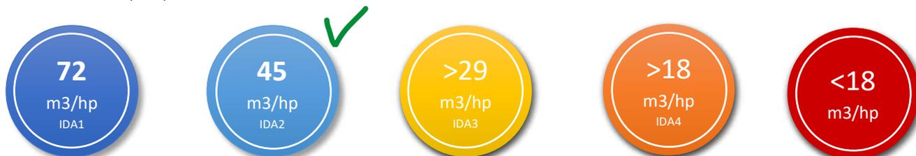
Esta tasa de ventilación por persona supone un incremento considerable del caudal de aire exterior que es necesario inyectar en los locales bajo la normativa preceptiva (RITE), y según la propia guía debería lograrse mediante el aumento de la tasa de ventilación o mediante la reducción del aforo, adecuándolo a los caudales de ventilación.
